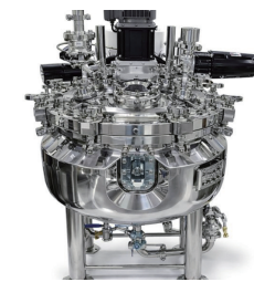
生物反应器 (Bio Tank)
